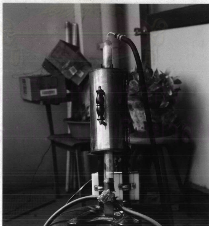
รูปที่ 3.2 ลักษณะภายในของท่อทองแดงสำหรับดูดออกซิเจนซึ่งใช้ในกระบวนการทำหลอด เลี้ยงเชื้อแบบไร้อากาศ
