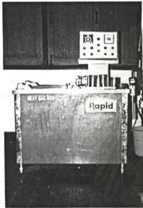
เครื่องย้อมและซักแบบโรตารีชนิดควบคุมอุณหภูมิ
