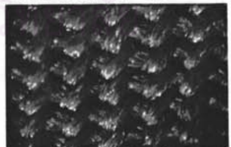
ผ้าดิบพอก เตรียมผ้าโดยใช้เรซิน ก. และย้อมสีได เรกท์ ลักษณะผ้าผืน ขยาย 20 เท่า
