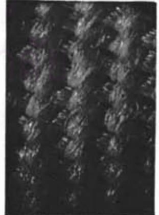
ผ้าดิบฟอก เตรียมผ้า โดยใช้ เรซิน ก. และย้อมสี ไต เรกท์ ขยาย 20 เท่า
