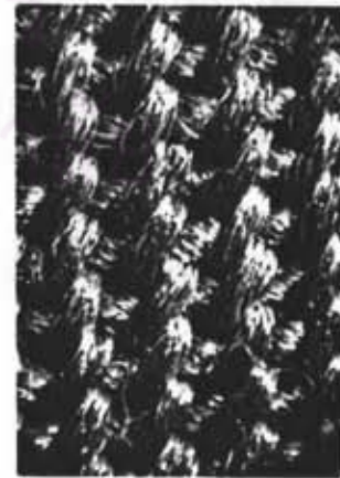
ผ้าดิบฟอก เตรียมผ้า โดยใช้เรซิน ก. และย้อมสีไโด เรกท์ ขยาย 20 เท่า
