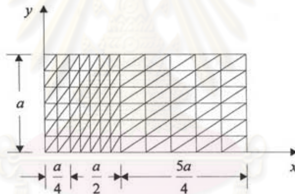
รูป 8.8 การแบ่งอิลีเมนต์บนภาคตัดขวางของท่อนำคลื่น บรรจุด้วยเฟอร์ไรต์ออกเป็น 144 อิลีเมนต์ 91 โหนด
