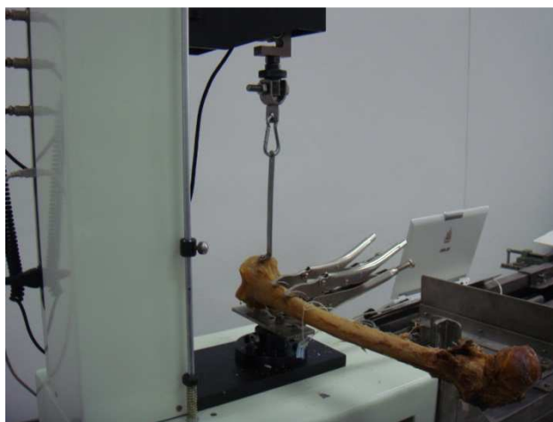
รูปที่ 28 รูปแบบการใส่สกรูและการวางกระดูกต้นขาส่วนปลาย
