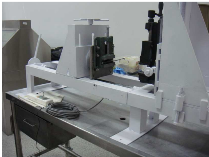
รูปที่ 25 ต่อเครื่องวัดแรงเข้ากับเครื่องดันกระดูกเพื่อวัดแรงกดสูงสุดที่ทำให้กระดูกเกิดการแตกหัก
