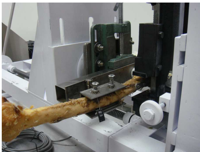
รูปที่ 26 วิธีรูปแบบการวางกระดูกต้นขาส่วนหัวเข้าที่เครื่องดันกระดูก
