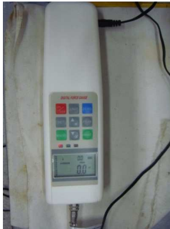
รูปที่ 11 เครื่องวัดแรง (Digital force gauge)
