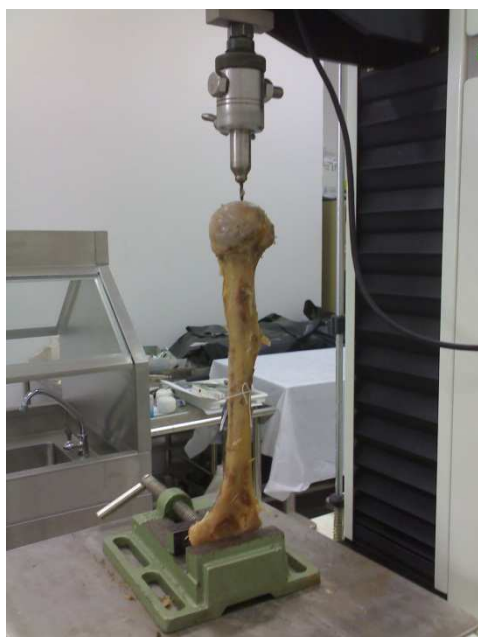
รูปที่ 23 รูปแบบการวางกระดูกต้นแขน เพื่อทำการวัดความแข็ง
