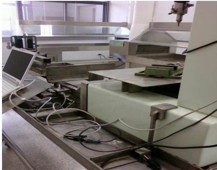
รูปที่ 21 ลักษณะการเชื่อมต่อเครื่องวัดเข้ากับคอมพิวเตอร์เพื่อทำการวัดความแข็ง
