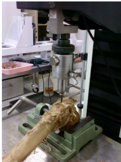
รูปที่ 22 รูปแบบการวางกระดูกต้นขา เพื่อทำการวัดความแข็ง
