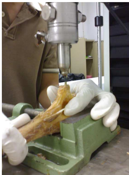
รูปที่ 23 รูปแบบการวางกระดูกต้นแขน เพื่อทำการวัดความแข็ง
