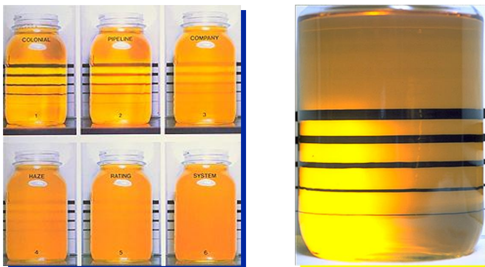
รูปที่ 4.8 แสดงการเกิดปฏิกิริยาออกซิเดชันในน้ำมันดีเซล [21]
