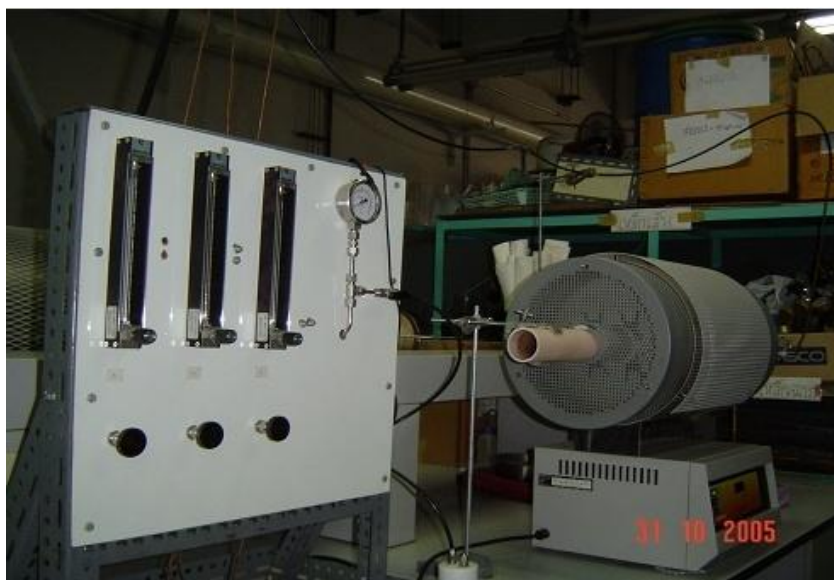
รูปที่ 2.7 ตัวอย่างเตาเผาอุณหภูมิสูงที่ต่อกับระบบแก๊สต่างๆ[8]
