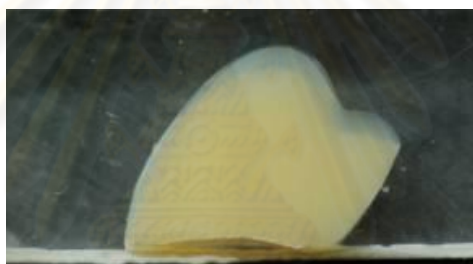
ภาพที่ 15 ซีฟันเทียมที่เตรียมสำหรับทดสอบความแข็งวิกเกอร์ส
