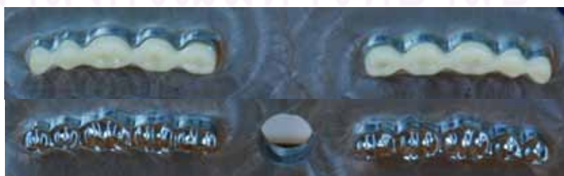
ภาพที่ 5 แม่พิมพ์ฟันอะคริลิกเทอร์โมพลาสติก
