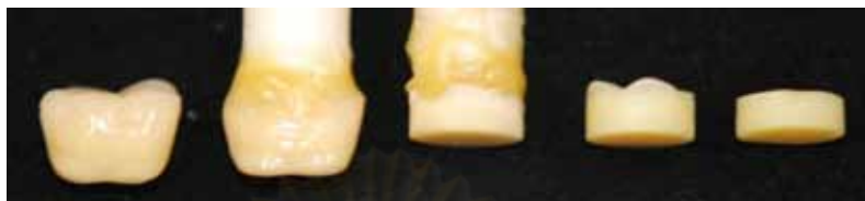
ภาพที่ 17 ชิ้นฟันเทียมที่เตรียมสำหรับการทดสอบการยึดติดกับวัสดุฐานฟันเทียม
