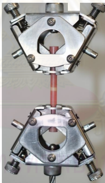
ภาพที่ 23 ที่จับชิ้นงานการทดสอบความแข็งแรงยึดติดแบบดึง
