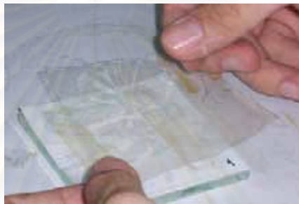
รูปที่ 3.6 วิธีการเคลือบแพลเลเดียมที่ผิวของเมมเบรน
