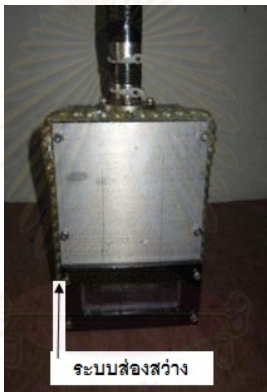
ภาพที่ 3.9 ไดโอดเปล่งแสงสำหรับส่องสว่างเพื่อการมองภาพที่ติดตั้งรอบระบบมองภาพ
