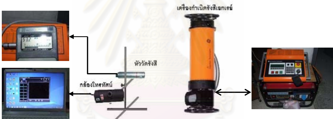
ภาพที่ 4.1 แผนภาพการจัดอุปกรณ์ศึกษาผลของพลังงานของรังสีเอกซ์ที่มีต่อกำหนดกล้องโทรทัศน์
