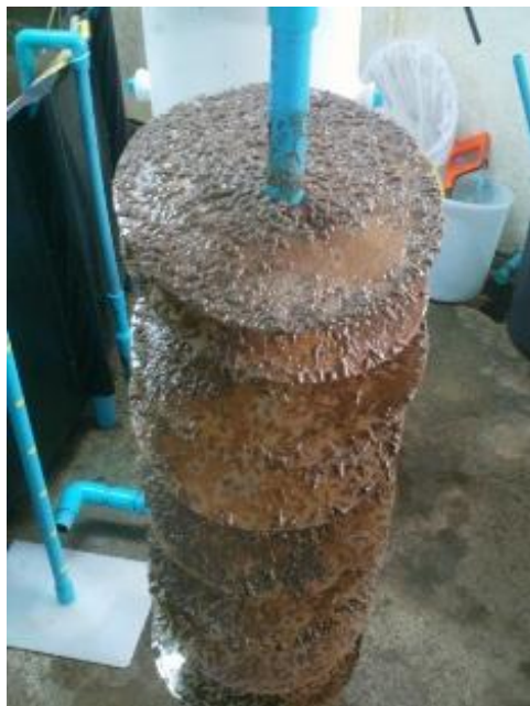
ภาพที่ 4.12 ลักษณะของแผ่นกั้นภายในหน่วยแยกตะกอนหลังจากใช้แยกตะกอนมาแล้ว 7 วันซึ่งพบตะกอนเกาะอยู่ที่แผ่นกั้นจำนวนมาก
