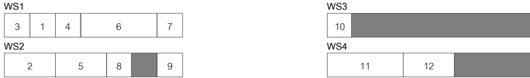
ภาพที่ 2.17 สายการประกอบผลิตภัณฑ์ผสมแบบสองด้านที่มีความสมดุล
