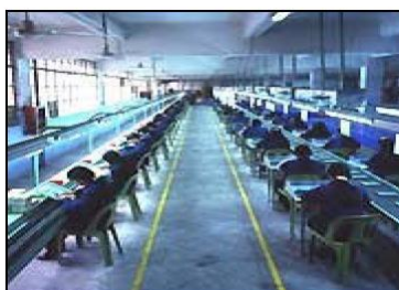
ภาพที่ 2.7 สายการประกอบแบบขนาน (Betancourt, 2007)
