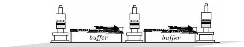
ภาพที่ 2.11 สายการประกอบแบบไหลไม่ต่อเนื่อง (Betancourt, 2007)
