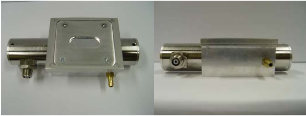
รูปที่ 3.8 ภาพถ่ายหัววัดรังสีแบบหน้าต่างด้านข้างและแวนโควางแนวขนานที่พัฒนาขึ้น
