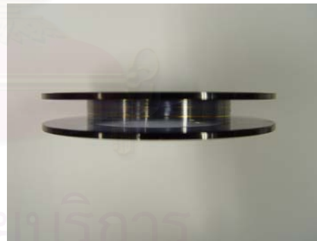
ข. ม้วนเส้นลวดทังสเตนเคลือบทองขนาด
