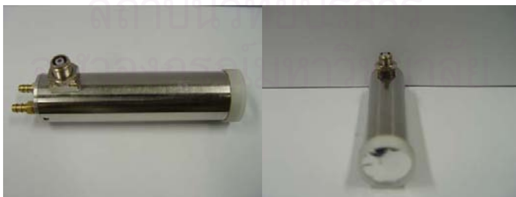
รูปที่ 3.11 ภาพถ่ายหัววัดรังสีแบบหน้าต่างด้านหน้าและแอดโนดวงแนวขนานที่พัฒนาขึ้น
