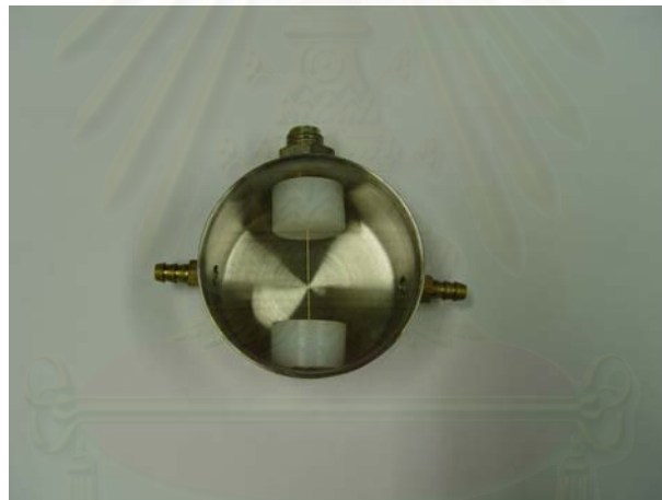
รูปที่ 3.14 ภาพถ่ายหัววัดรังสีแบบหน้าต่างด้านหน้า และแอนโอดวางแนวตั้งฉากกับผนังแคโทดที่พัฒนาขึ้น
