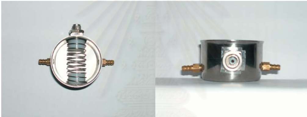
รูปที่ 3.16 ภาพถ่ายหัววัดรังสีแบบหน้าต่างด้านหน้าและแอดวามวางแนวตั้งจากกับผนังแคโทดที่มีขดลวดสปริงรอบแอดวามที่พัฒนาขึ้น
