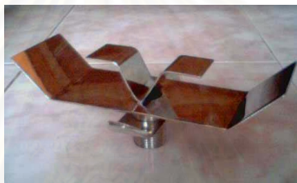
รูปที่ 2.22 หัวฉีดแบบใหม่ rebound nozzle สำหรับกระจายอนุภาค ภายในเครื่องทดสอบขนาด 20 ลิตร
