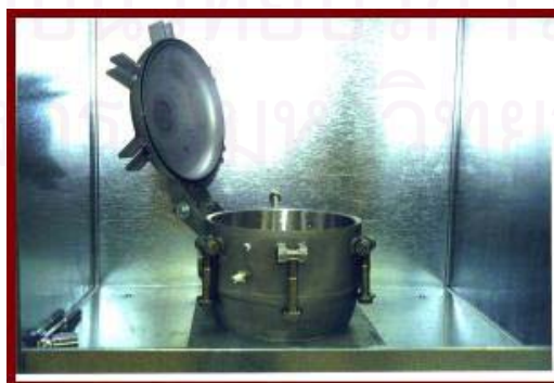
รูปที่ 2.13 เครื่องทดสอบการระเบิดของอนุภาคขนาด 20 ลิตร ของ US Bureau of Mines (Cashdollar and Hertzberg, 1985)
