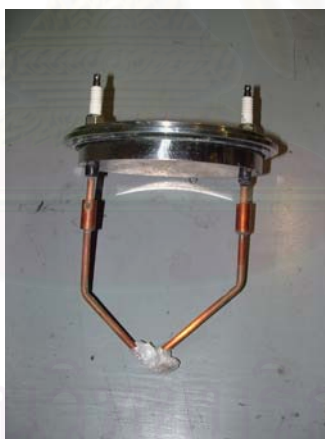
รูปที่ 4.1 การใส่สารจุดชนวนระเบิดที่ปลายหัวอิเล็กโทรด
