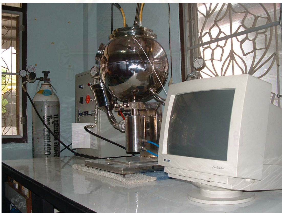
รูปที่ 3.13 ภาพถ่ายชุดเครื่องมือทดสอบวัดความดันจากการระเบิดของวัสดุอนุภาค จุฬาลงกรณ์มหาวิทยาลัย
