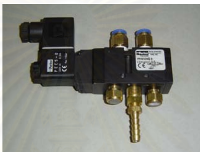
รูปที่ 3.9 โซลินอยด์วาล์วจ่ายลมอัดให้วาล์วทรงกระบอก
