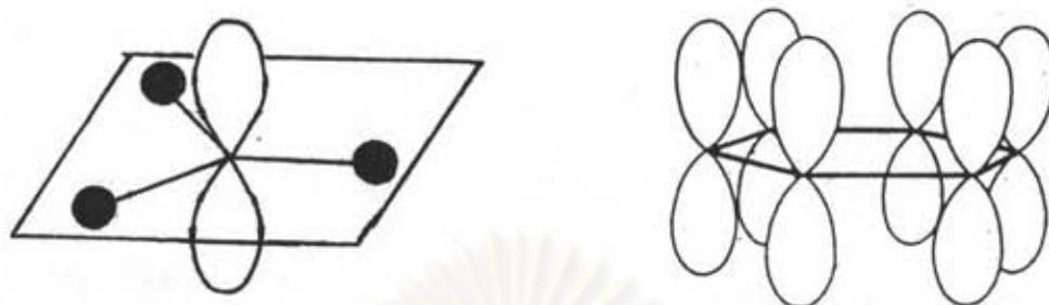
รูปที่ 2.1 แสดงตำแหน่งของออร์บิทัลของคาร์บอนที่เกิดจาก เอสพี-2 ไฮบริไดเซชัน
