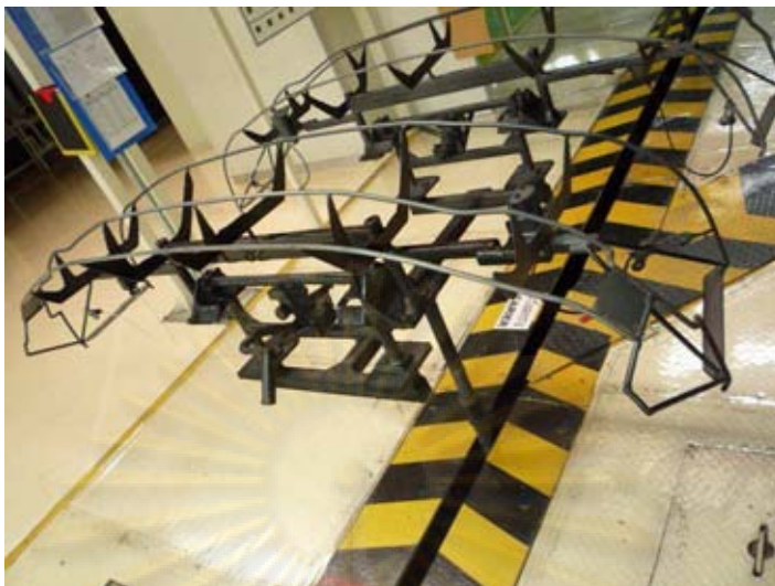
รูปที่ 5.2 ภาพตัวจับยึดชิ้นงานที่ใช้ในระบบการพ่นสี
