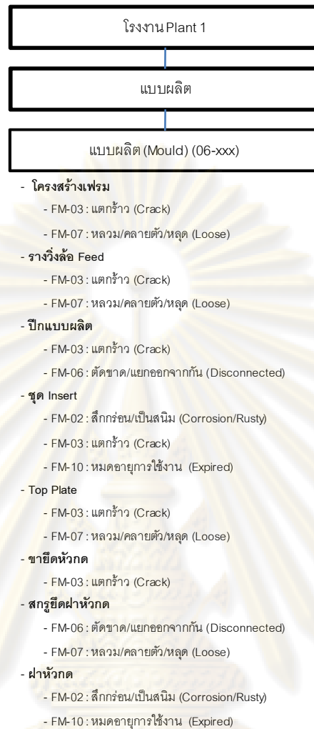
รูปที่ 3.8 โครงสร้างประวัติเครื่องจักรและรูปแบบการเสียของเครื่องจักรที่ดำเนินการศึกษา ในระบบแบบผลิต โรงงาน Plant 1
