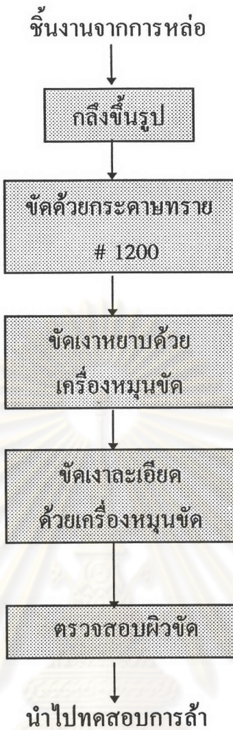
รูปที่ 4.7 ขั้นตอนการเตรียมชิ้นทดสอบความล้า
