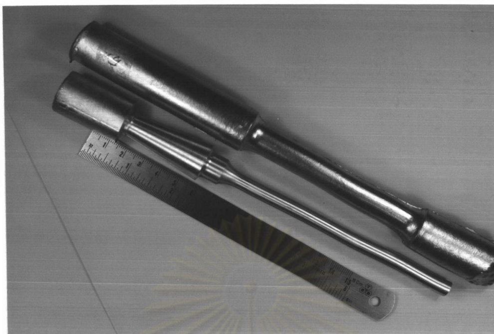
รูปที่ 4.9 ชิ้นงานที่ได้จากการหล่อเปรียบเทียบกับชิ้นงานที่ผ่านการกลึงขึ้นรูป
