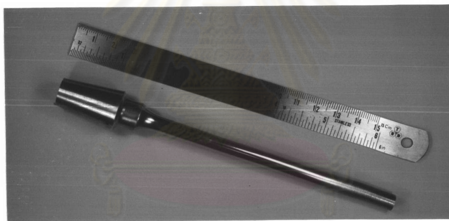
รูปที่ 4.10 ชิ้นงานที่ผ่านการขัดเงาเป็นชิ้นงานที่พร้อมจะทดสอบอายุการล้า
