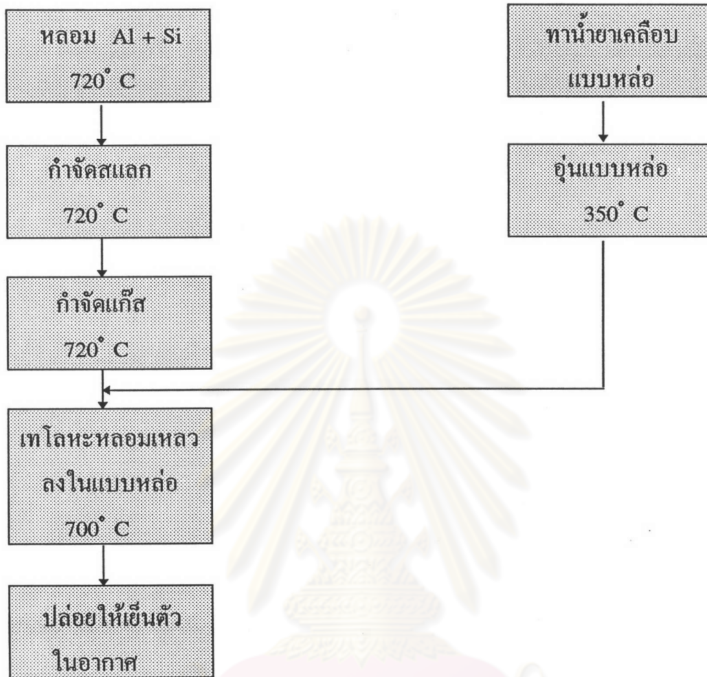
รูปที่ 4.1 การหล่อหลอมอะลูมิเนียมผสม
