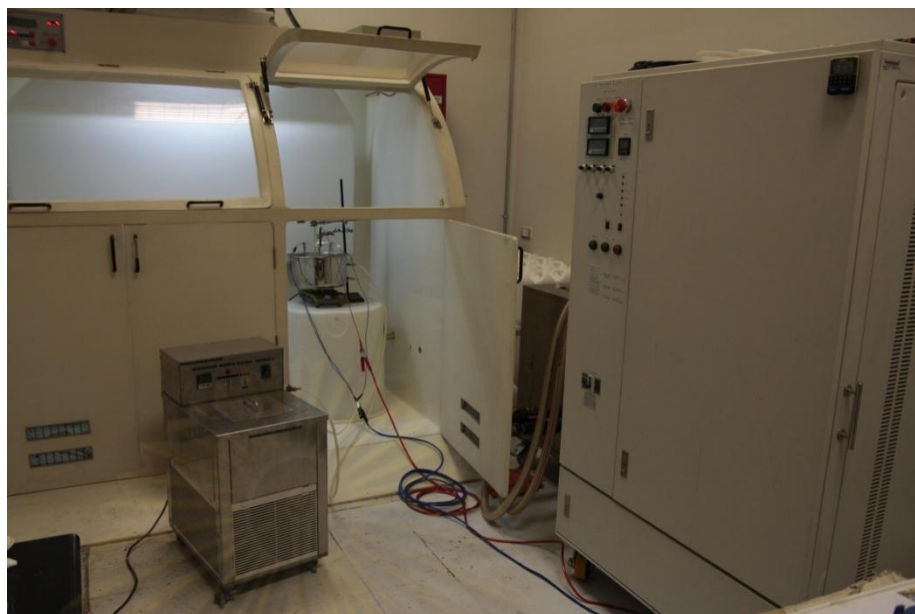
รูปที่ 4 แสดงการต่อเครื่องกำเนิดไฟฟ้าและเครื่องหล่อเย็นเข้ากับชิ้นงานในการทำแอนโนไดเซชัน
