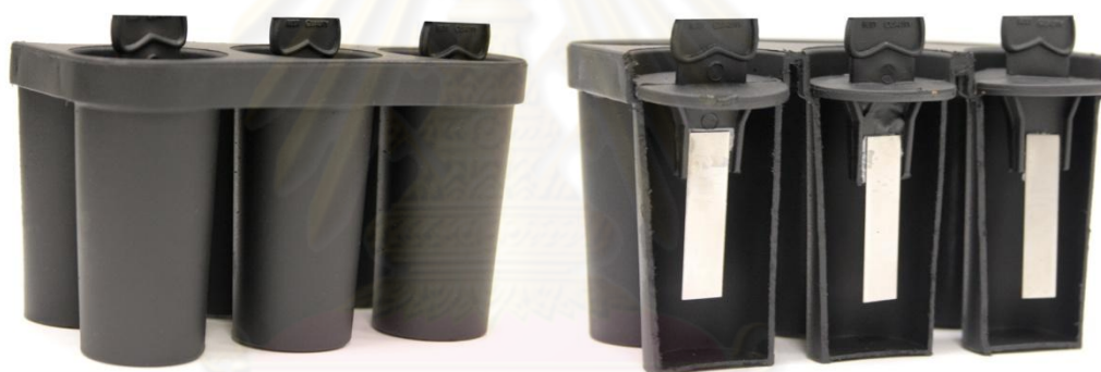
รูปที่ 10 แสดงการแช่ชิ้นงานไทเทเนียมในสารละลายเอสบีเอฟ
