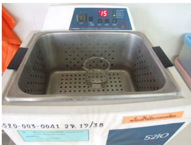
รูปที่ 3 การทำความสะอาดด้วยเครื่องอัลตราโซนิคในสารละลายอะซีโตน 5 นาที
