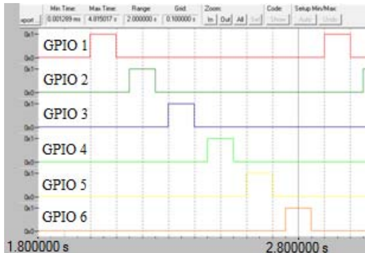
ภาพที่ 27 ลักษณะสัญญาณที่บอร์ดไมโครคอนโทรลเลอร์ใช้ในการกำหนดการเปิด-ปิดหลอดอินฟราเรด
