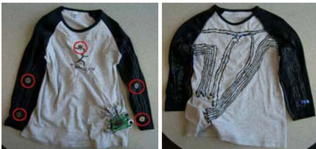
ภาพที่ 4 ตัวอย่างของเสื้อที่มีตัวตรวจจับความเร่งอยู่ตามจุดที่สนใจ [6]
