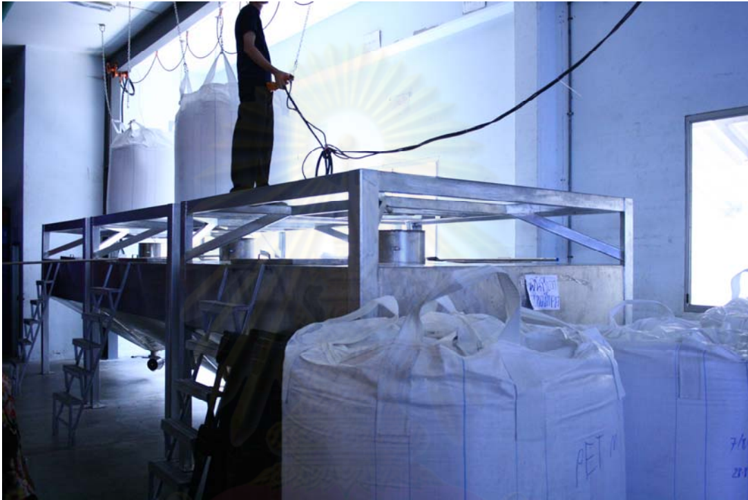
รูปที่ 3.19 การนำเม็ดพลาสติกเทใส่เครื่องจักร
