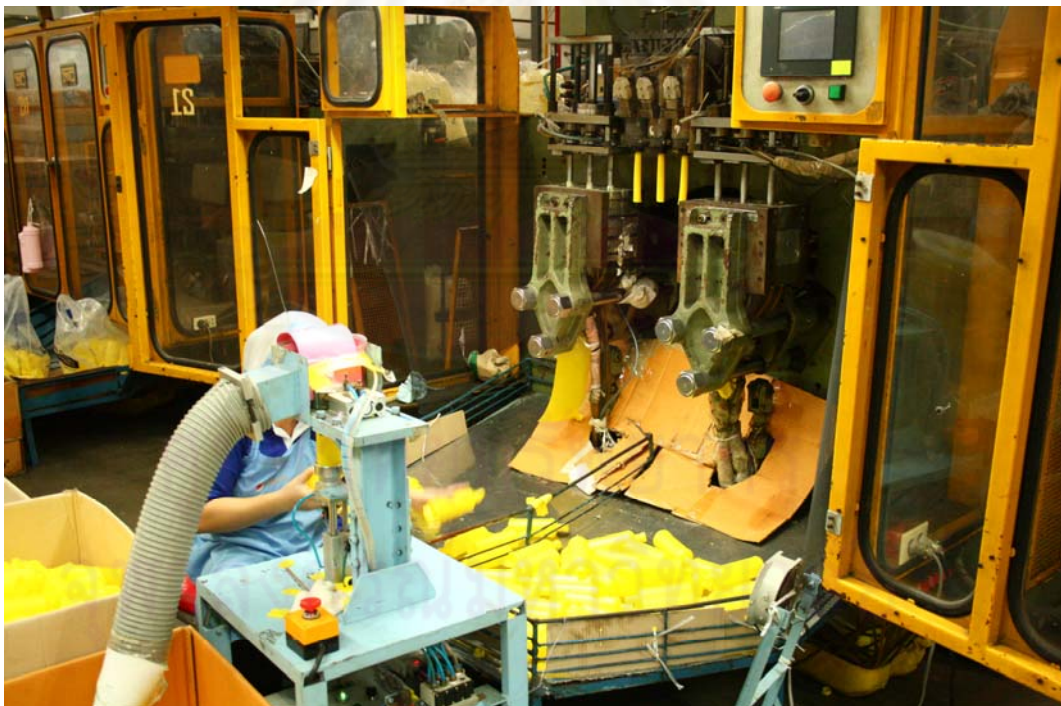
รูปที่ 3.16 เครื่องเป่าขึ้นรูปแบบเอ็กซ์ทรูด (Extrusion Blow Molding) ที่ใช้ในโรงงาน
