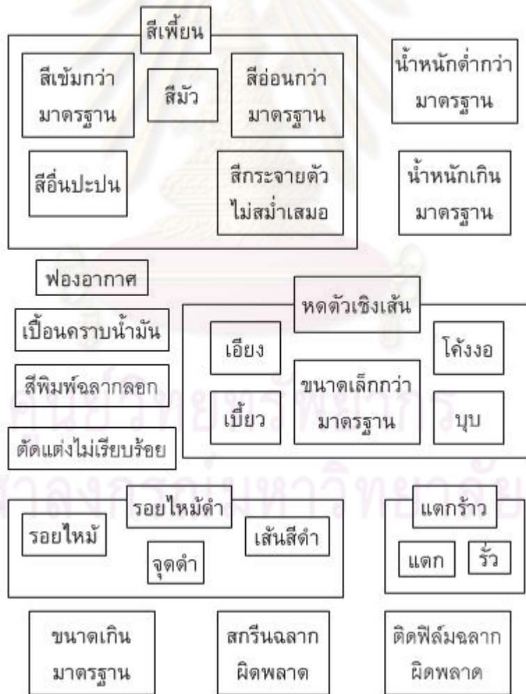
รูปที่ 4.1 แผนผังความคล้ายคลึงของปัญหาของเสียในการผลิตขวด
