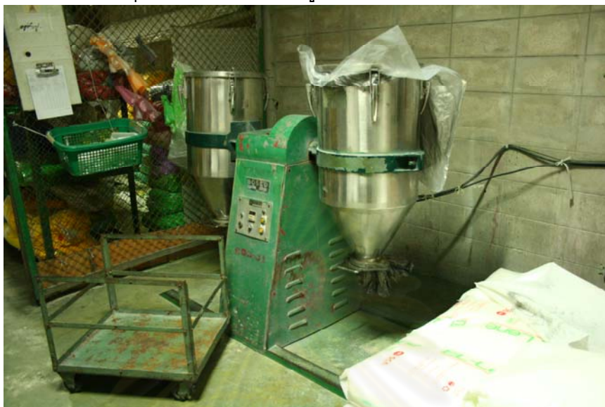
รูปที่ 3.12 ถังผสมแบบหมุนแกว่งที่ใช้ในโรงงาน
