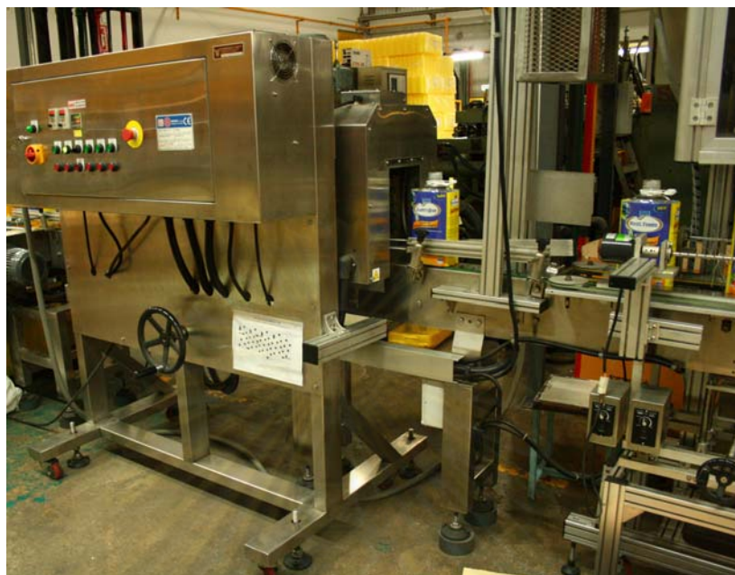
รูปที่ 3.24 เครื่องติดฟิล์มฉลากที่ใช้ในโรงงาน
