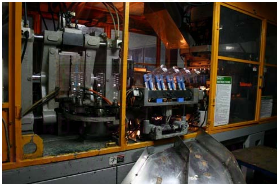
รูปที่ 3.21 เครื่องเป่าขึ้นรูปแบบฉีดเป่า (Injection Blow Molding) ที่ใช้ในโรงงาน
