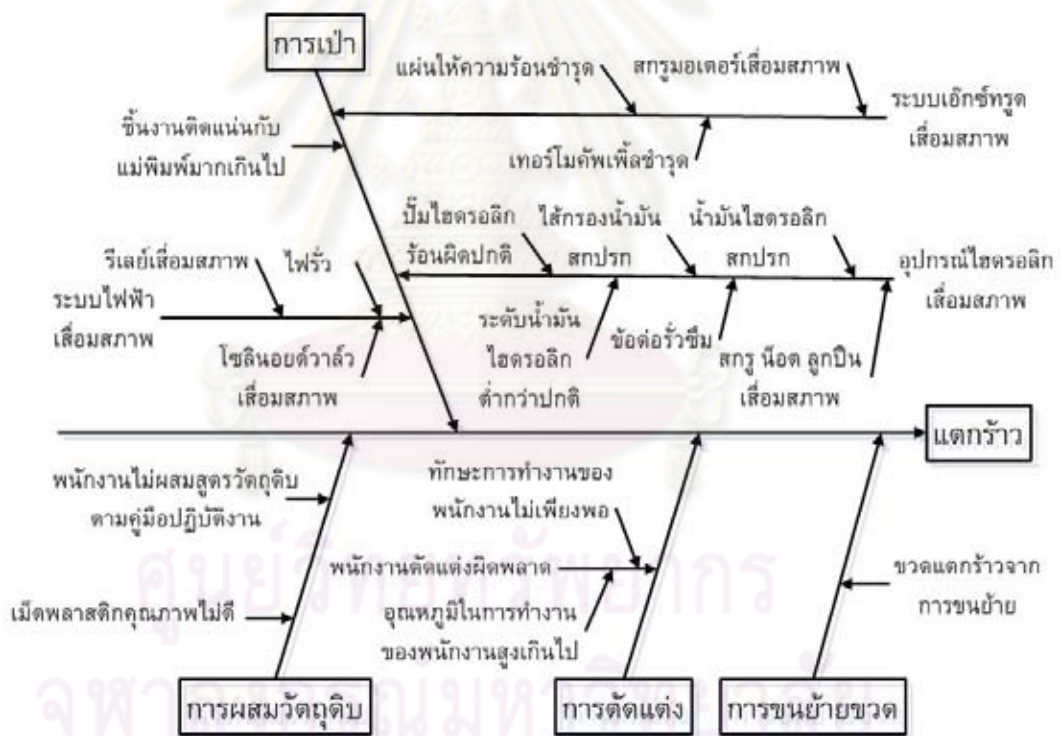
รูปที่ 4.7 แผนผังสาเหตุและผลแสดงสาเหตุของการแตกร้าวในการผลิตขวด PE, PP และ PVC
