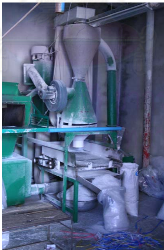
รูปที่ 3.18 เครื่องบดเศษพลาสติก PET ที่ใช้ในโรงงาน
