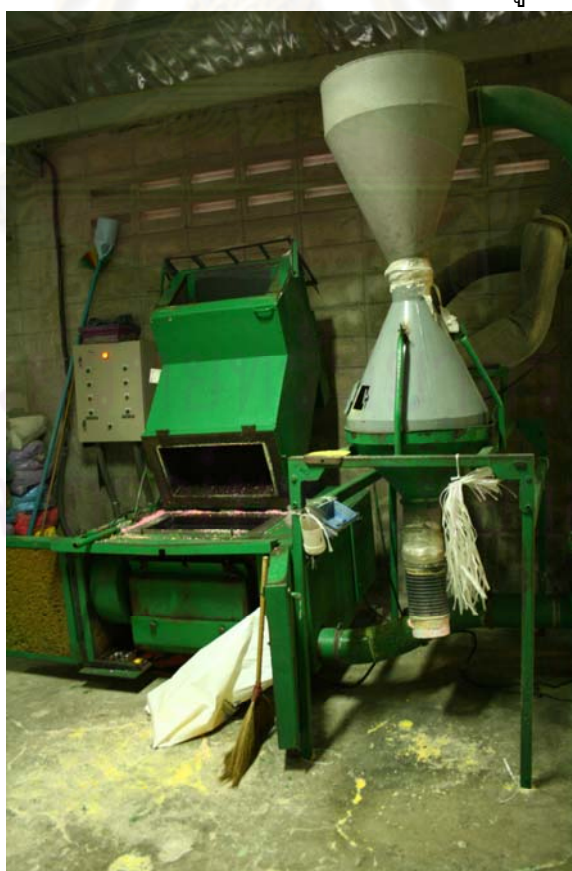
รูปที่ 3.11 เครื่องบดเศษพลาสติก PE, PP, PVC ที่ใช้ในโรงงาน
