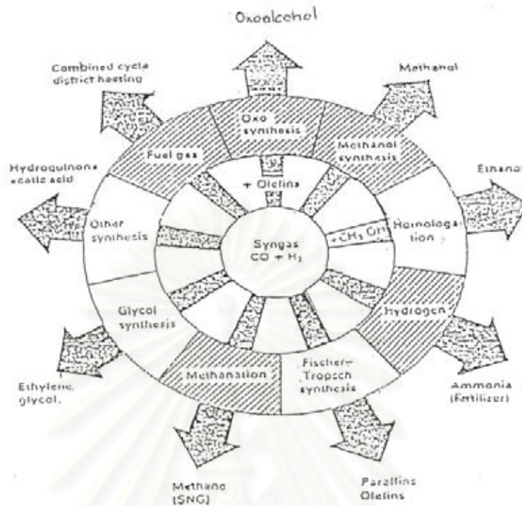
รูปที่ 2.6 ผลิตภัณฑ์ขั้นต้นที่ได้จากการใช้แก๊สสังเคราะห์เป็นวัตถุดิบ [17]
