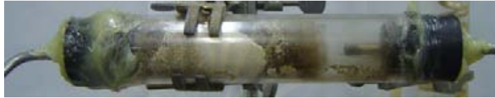
รูปที่ 3.8 เครื่องแยกไอน้ำออกจากผลิตภัณฑ์แก๊ส
