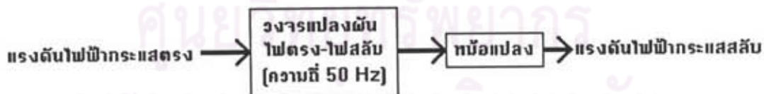
รูปที่ 1.1 หลักการทำงานของอินเวอร์เตอร์ทั่วไป
