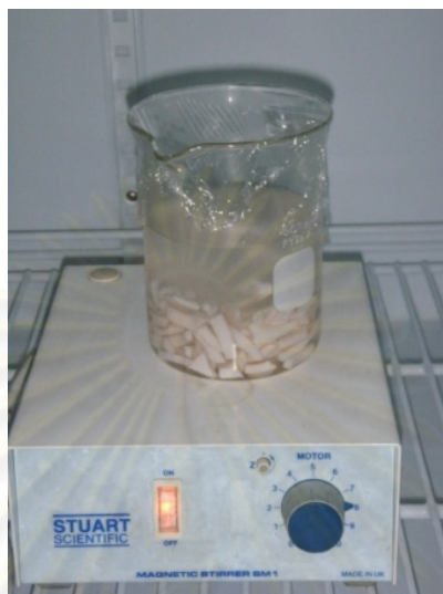
ภาพที่ 3 การบั่นหมุนหนังสือกรในสารละลายกรดที่ผสมเอนไซม์เปปซิน
