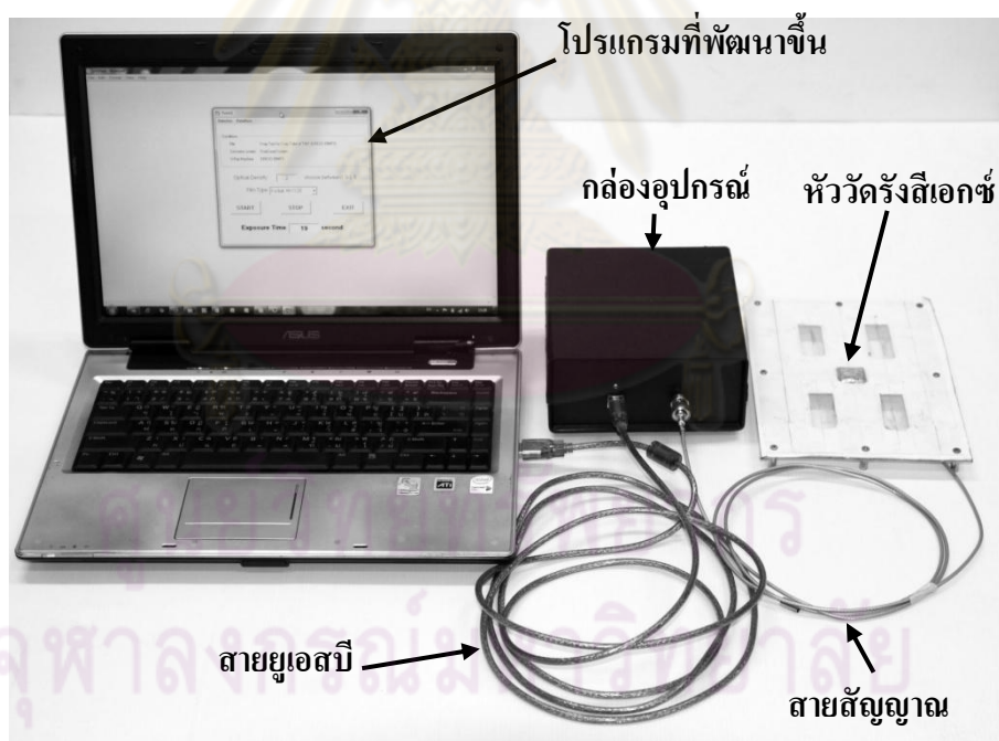
รูปที่ จ.1 ชุดอุปกรณ์วัดความเข้มรังสีเอกซ์ทะลุผ่านเพื่อใช้หาเวลาที่เหมาะสมในการถ่ายภาพ
