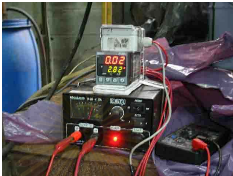
รูปที่ 3.10 หน้าจอแสดงความเร็วอากาศปฐมภูมิแบบดิจิทัล
