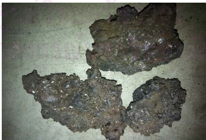
รูปที่ 4.5 แสดงการหลอมตัวของเบดที่อุณหภูมิสูงกว่า 1000 องศาเซลเซียส
