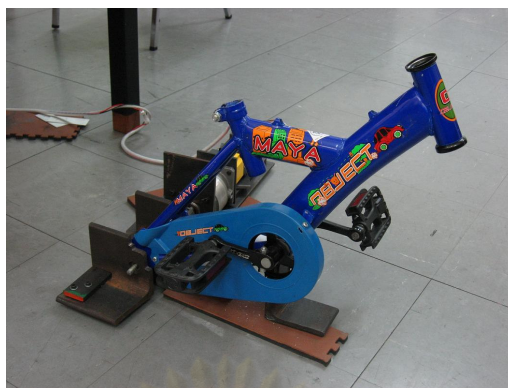
รูปที่ 3-11 อุปกรณ์ควบคุมการเคลื่อนที่สำหรับการทดสอบเบื้องต้น
