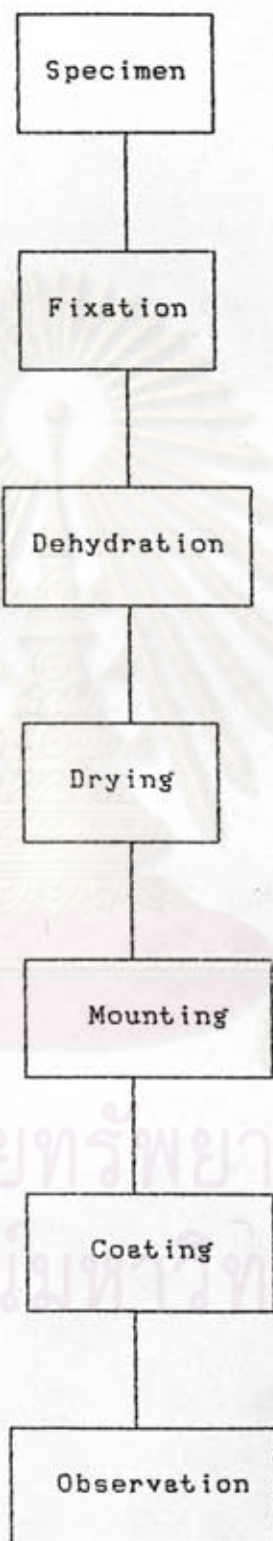
แผนภูมิที่ 2 ขั้นตอนการเตรียมตัวอย่างสำหรับการศึกษาด้วย SEM
