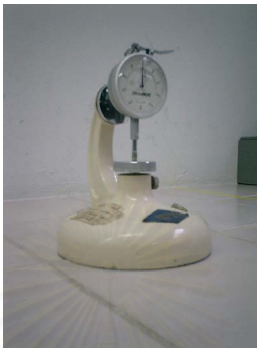
รูปที่ ๑.๑ เครื่องวัดความหนาของชิ้นงาน (micrometer)
