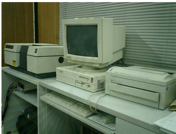
รูปที่ จ.1 เครื่อง Fourier transform infrared spectrophotometer (FT-IR, Nicolet รุ่น Impact 400D)
