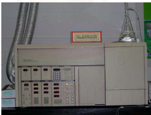
รูปที่ ๓.4 เครื่อง Gel permeation chromatograph (GPC,Waters รุ่น 150-CV)
