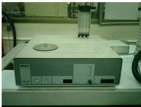
รูปที่ ๕.6 เครื่อง Differential scanning calorimeter (DSC, Netzsch รุ่น DSC 200)
