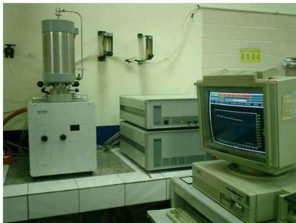
รูปที่ ๕.5 เครื่อง Thermogravimetric analyzer (TGA, Netzsch รุ่น STA 409C)
