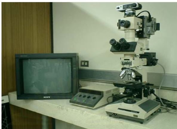
รูปที่ ๓.3 เครื่อง Optical microscope (OM, Olympus รุ่น BH2-UMA)
