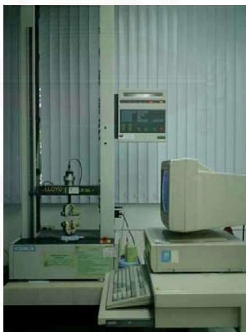
รูปที่ จ.2 เครื่อง Tensile testing machine (LLOYD: Model LR 5K)
