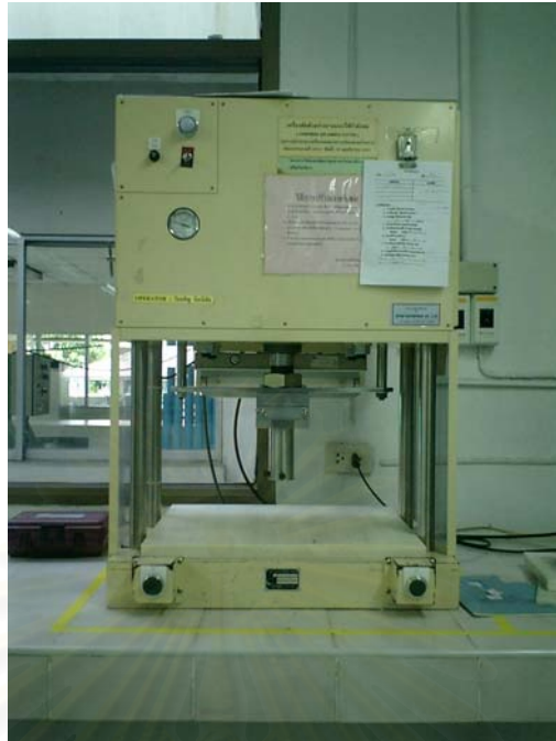
รูปที่ ๗.7 เครื่องตัดชิ้นทดสอบสำหรับทดสอบสมบัติด้านแรงดึงและความทนแรงฉีกขาด
