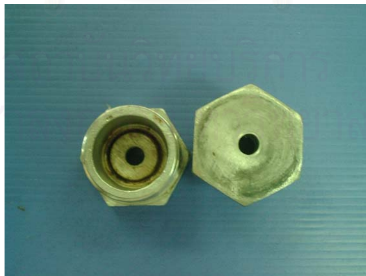
รูป ง.6 ฝาปิดเปิดของช่องสำหรับสูมตัวอย่าง
