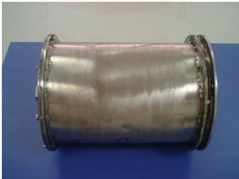
รูป ง.2 ตัวถังหมักทรงกระบอกขนาด 20.8 x 33 เซนติเมตร
