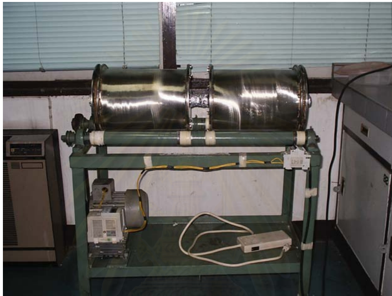
รูป ง.1 ถังหมักทรงกระบอกแบบหมุนบนแท่นหมุน
