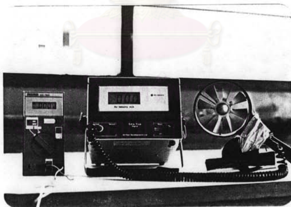
รูปที่ 3.12 อุปกรณ์ไมล์ติมิเตอร์และเครื่องวัดความเร็วลม
