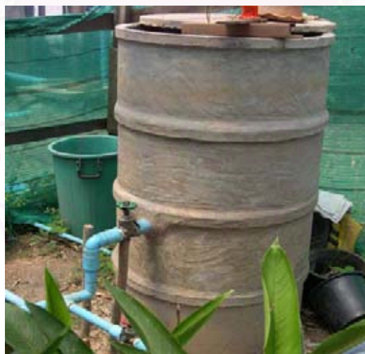
รูปที่ 3.4 ถังเก็บน้ำรวมที่ใช้ในการทดลอง (น้ำทิ้งผสมกับปุ๋ยสวะ)
