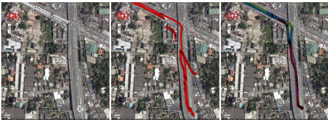
รูปที่ 4.9 Trajectory ที่ได้จากระบบ GPS อย่างเดียว (a) IMU (b) และ GPS/IMU (c)
