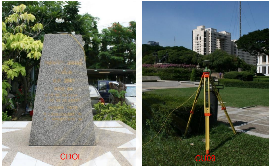
รูปที่ 4.11 สถานีฐาน GNSS ที่ติดตั้งบนหมุดหลักฐานถาวรในพื้นที่
