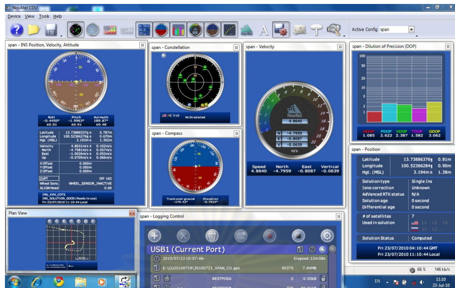
รูปที่ 3.3 หน้าจอการทำงานของโปรแกรม NovAtel CDU ในขณะที่เก็บข้อมูล GPS/IMU
