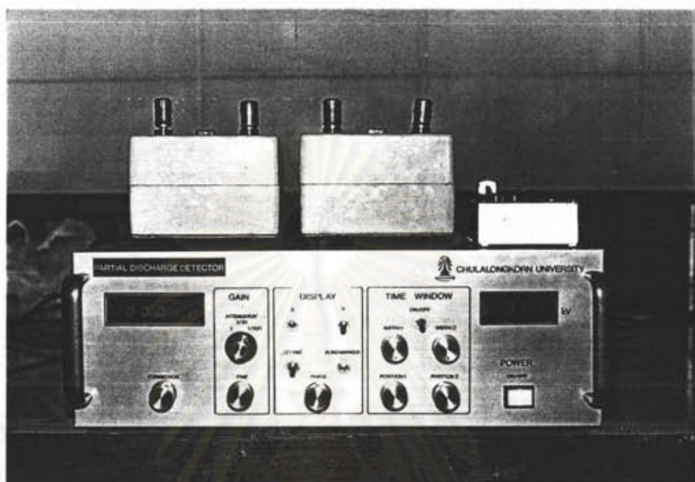
รูปที่ 3.32 เครื่องตรวจจับ PD ที่ประกอบสมบูรณ์.
