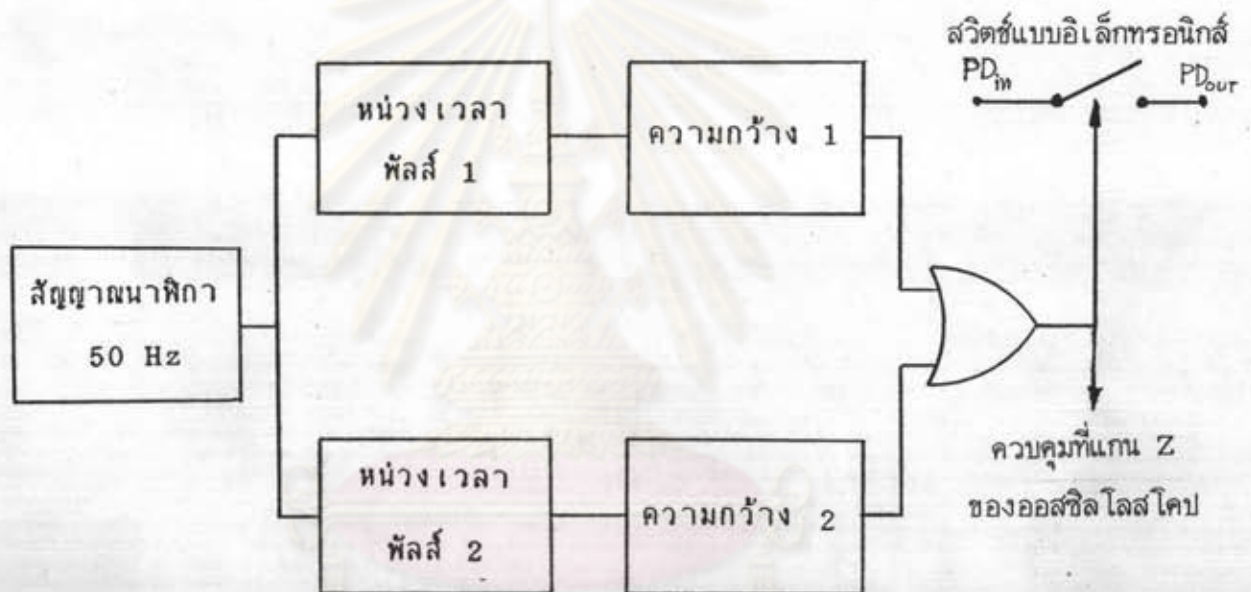
รูปที่ 3.15 ไดอะแกรมอย่างง่ายของวงจรหน้าต่างเวลา
