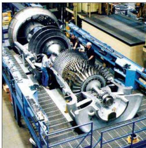
รูปที่ 2.5 ระบบผลิตไฟฟ้าพลังงานความร้อนร่วมด้วยกังหันก๊าซ (Gas Turbine Cogeneration Plant)
