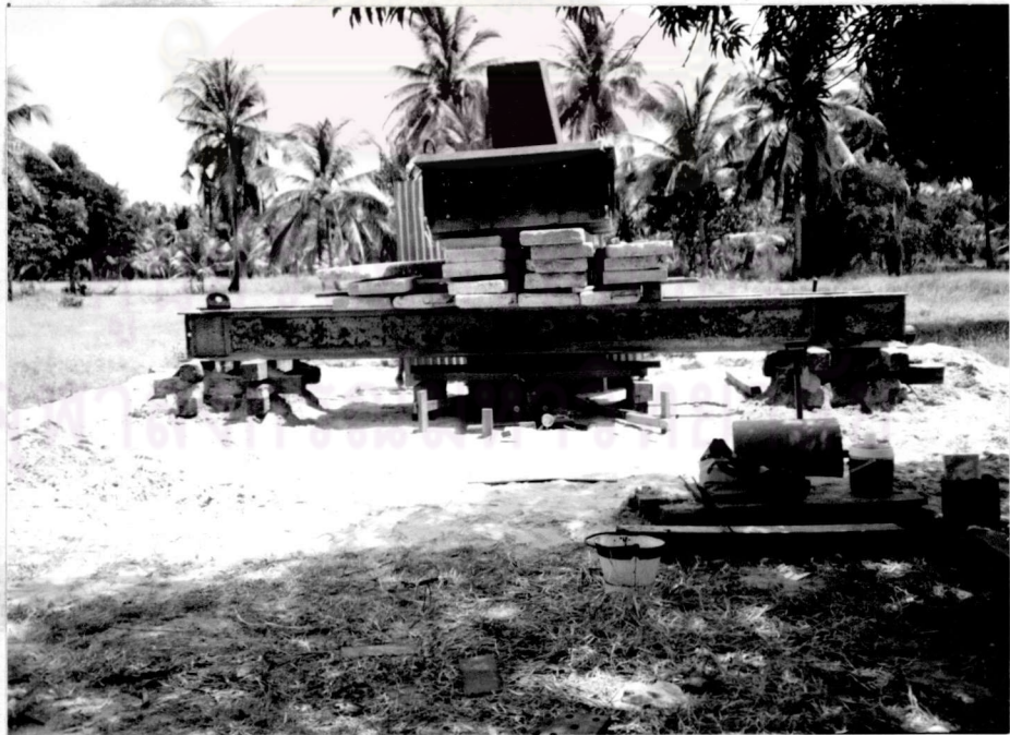
รูปที่ 3.6 แสดงน้ำหนักต้านเป็นก้อนน้ำหนักวางบนคานสำหรับทดสอบ Plate Bearing Test
