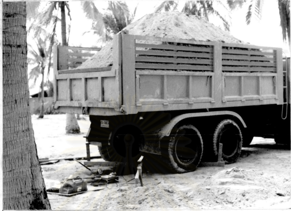
รูปที่ 3.5 แสดงน้ำหนักต้านเป็นรถบรรทุก + น้ำหนักบรรทุกสำหรับทดสอบ Plate Bearing Test
