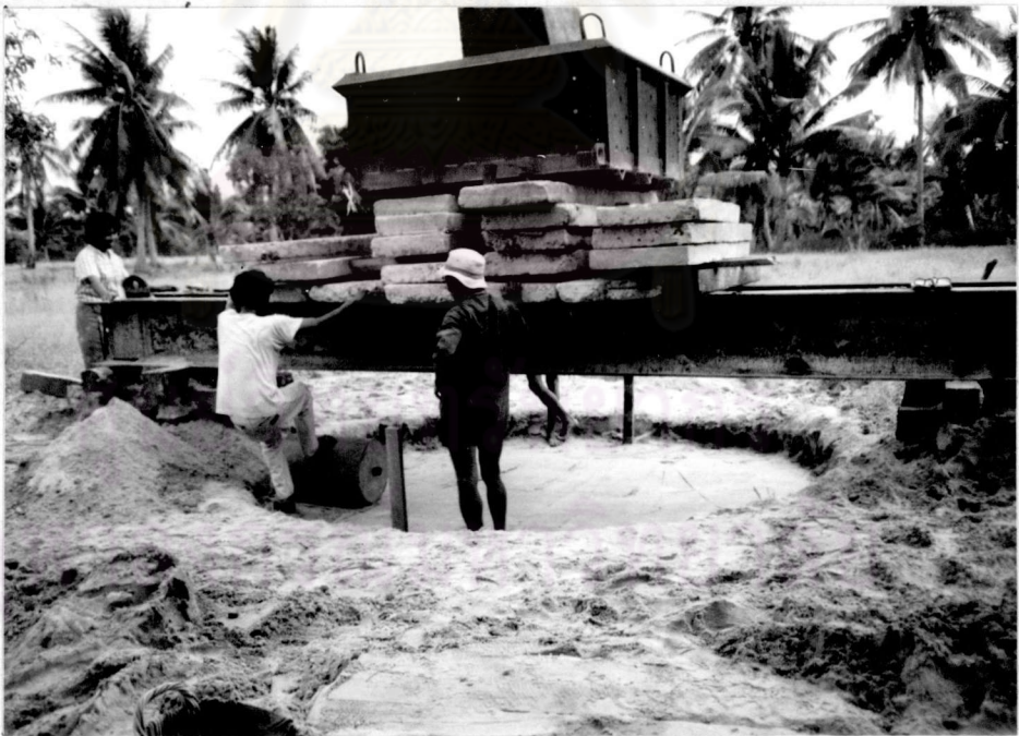
รูปที่ 3.10 แสดงการเตรียมตัวอย่างทรายจำลองสภาพโดยการบดอัดด้วยล้อคอนกรีตต้น
