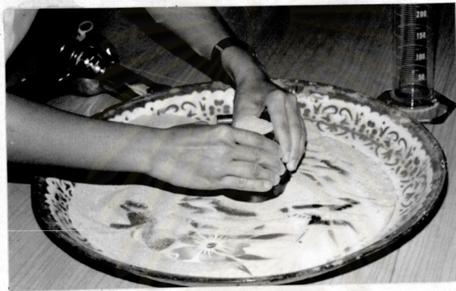
(ค) ยกกรวยทองเหลืองขึ้นตรง ๆ ทรายจะไหลลงทันที
