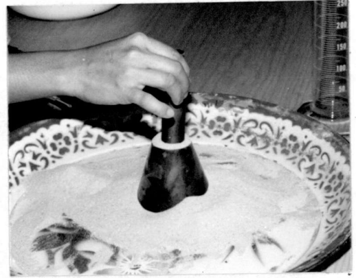
(ก) เป่าลมร้อนจนทรายมีความชื้นพอเหมาะ (ข) บดอัดทรายขึ้นนั้นในกรวยปลายตัดกระทุ้ง 25 ครั้ง
