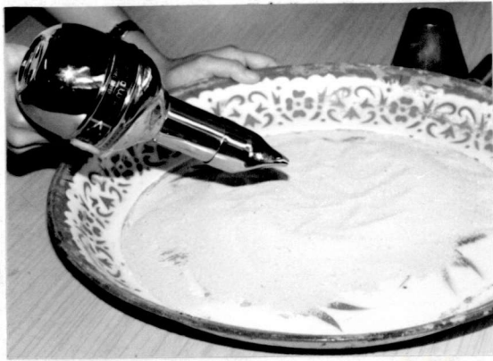
(ก) เป่าลมร้อนจนทรายมีความชื้นพอเหมาะ (ข) บดอัดทรายขึ้นนั้นในกรวยปลายตัดกระทุ้ง 25 ครั้ง
