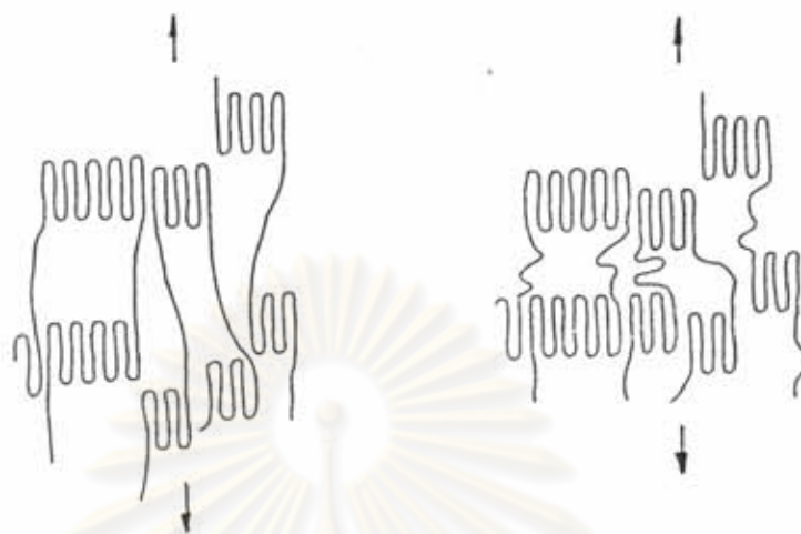
รูปที่ 2.24 ลักษณะ tie chain ที่เกิดขึ้นเนื่องจากแรงดึง ( Daniels, 1989a )
