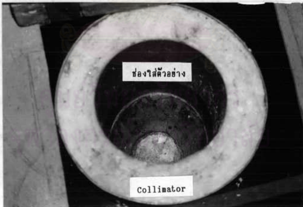
รูปที่ 3.9 รูปถ่ายท่อคอลลิเมเตอร์ของระบบอาบรังสีที่ใช้ในงานวิจัย (มองจากด้านบน)
