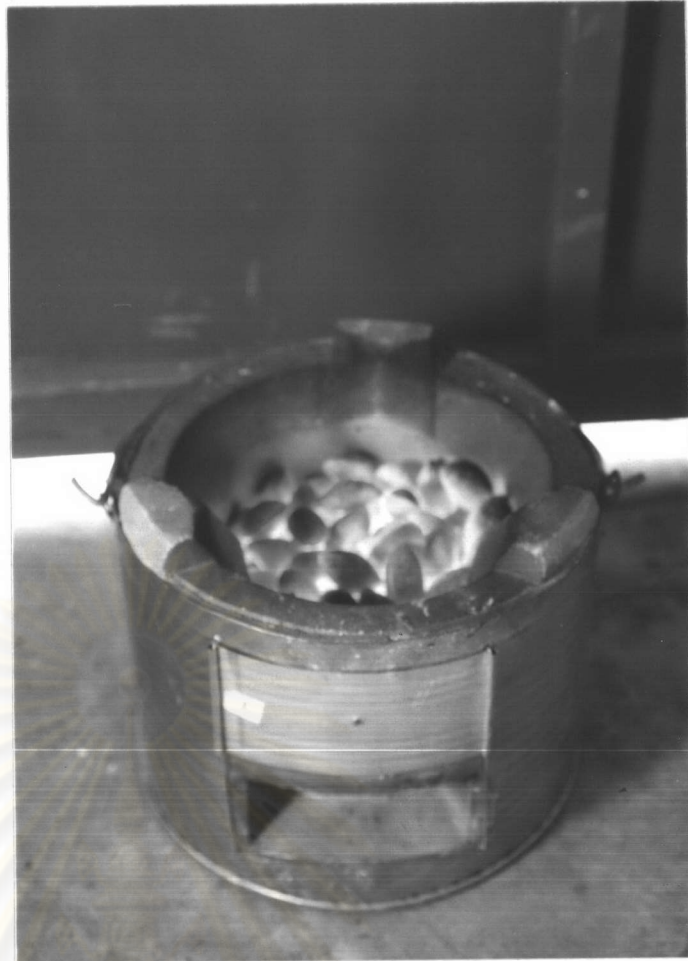
ภาพที่ 4.4 การลวกไหม้ของถ่านสังเคราะห์จากการคาร์บอนไนซ์ ที่อุณหภูมิ 600 องศาเซลเซียส ใช้แป้งเปียกเป็นตัวประสาน
