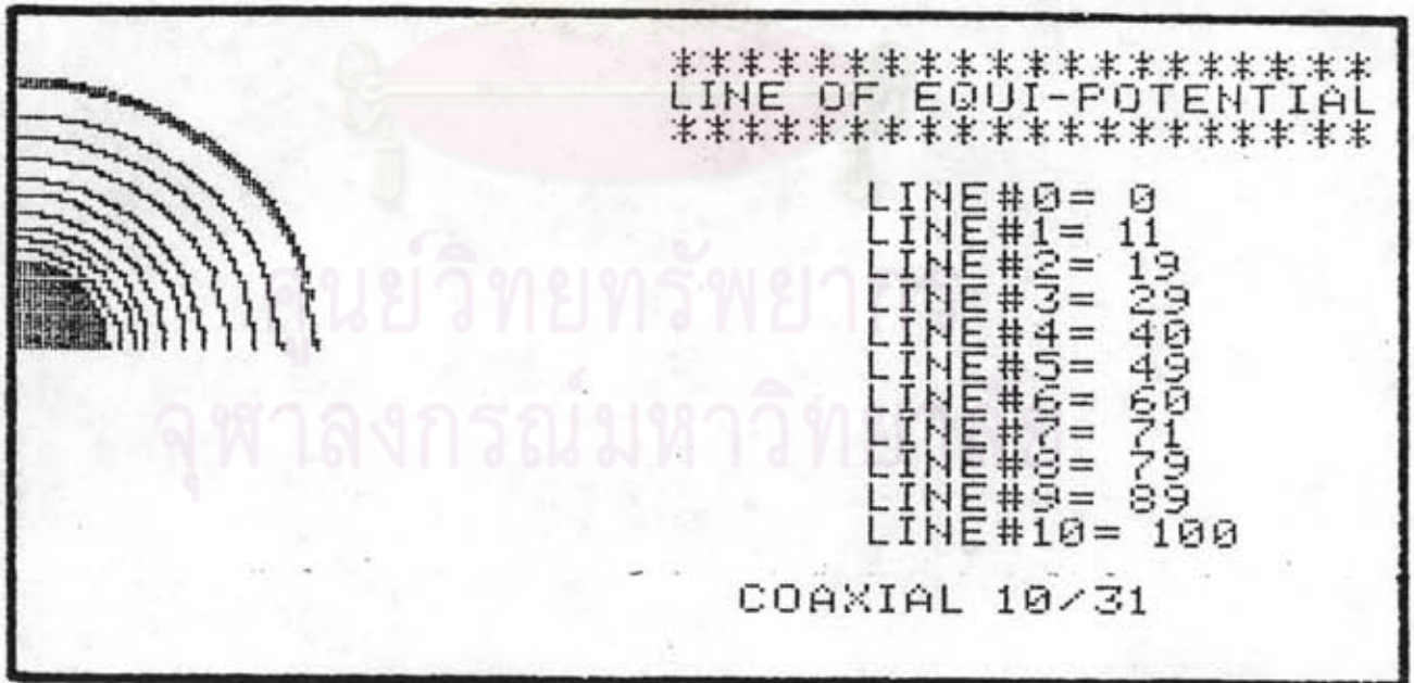
รูปที่ 4.7 ข ตัวอย่างการแสดงผลของโปรแกรมย่อย EQUI-POTENTIAL ของทรงกระบอกซ้อนกันร่วมที่มีสมมาตรตามระยะทาง
