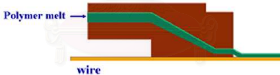
รูปที่ 4.1: โดเมนของหัวด้ายแบบทิว์บูลิ่งที่พิจารณา
