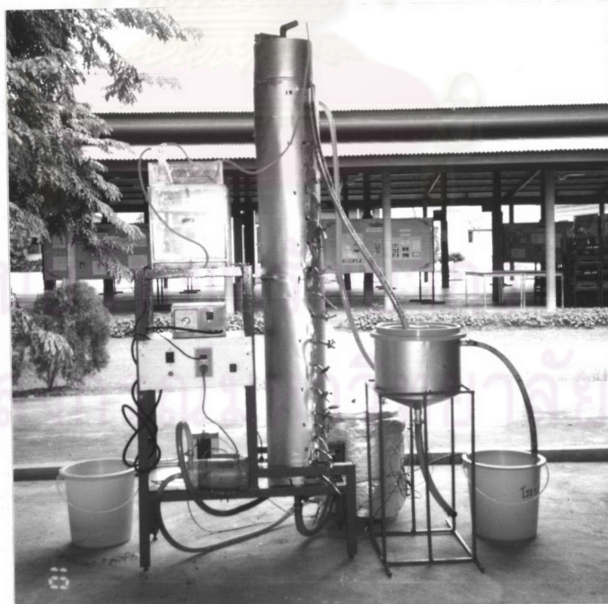
รูปที่ 3.2 แสดงระบบยูเอเอสบีที่ใช้ในการทดลอง (ด้านหลัง)
