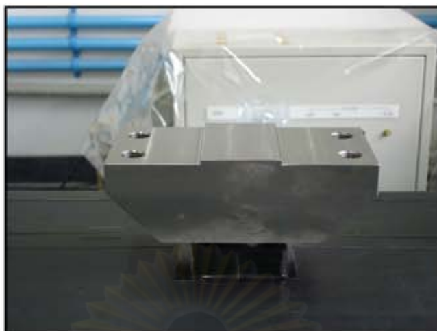
รูปที่ 3.13 หน้าแปลนส่วนล่างของเครื่องทดสอบความล้า
