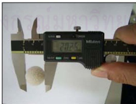
รูปที่ 3.33 การวัดเส้นผ่านศูนย์กลางของชิ้นงานทรงกลม
