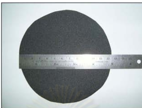
รูปที่ 3.20 กระดาษทรายที่นำมาใช้ติดกับจานหมุน
