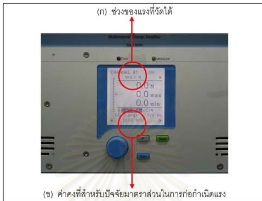
รูปที่ 3.32 การปรับตั้งไดนาโมมิเตอร์และเครื่องขยายสัญญาณประจุ
