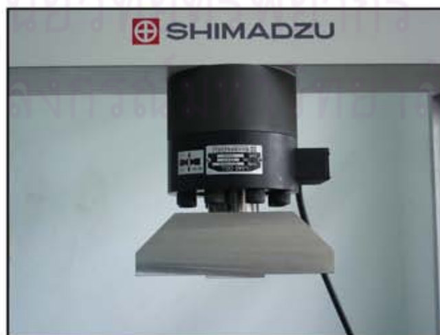
รูปที่ 3.17 หน้าแปลนส่วนบนของเครื่องทดสอบความล้า
