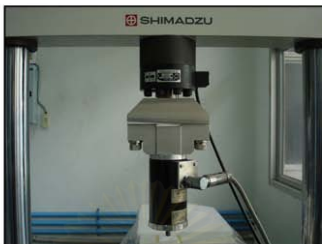
รูปที่ 3.18 หน้าแปลนส่วนบนของเครื่องทดสอบความล้า เมื่อใช้ในการจับยึดมอเตอร์
