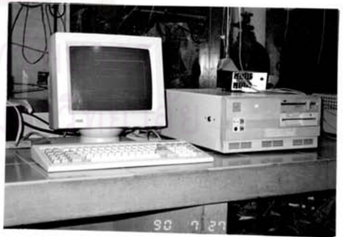
รูปที่ 3.6 ไมโครคอมพิวเตอร์ควบคุม อุณหภูมิภายในเครื่องปฏิกรณ์
