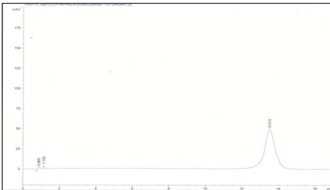
ภาพที่ 8 retention time ของสารละลายมาตรฐานริบาวดีไอโซไซด์ เอ 10 \mu l ที่ความเข้มข้น 2 mg/ml
