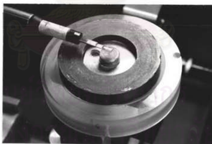
รูปที่ ผ-5 แสดงการวางหัววัดแม่เหล็กเพื่อวัด B_y
