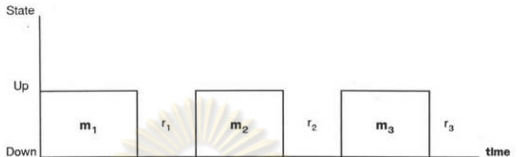
รูปที่ 3.3 สถานะการทำงานของอุปกรณ์ใด ๆ ในระบบ
