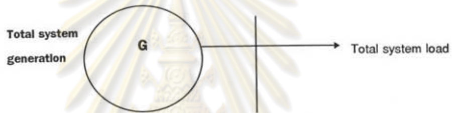
รูปที่ 3.2 แบบจำลองสำหรับใช้คำนวณความเชื่อถือได้ของระบบผลิตไฟฟ้ากำลัง
