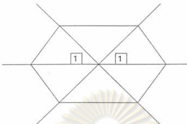
รูปที่ 4.12a ลำดับการเกิดจุดหมุนพลาสติกของการวิเคราะห์ผลาสติก-พลาสติกอันดับที่ 2
