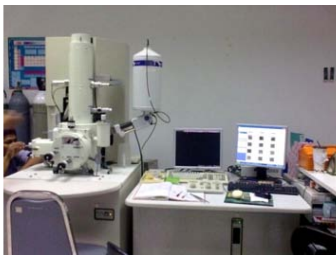
รูปที่ 3.9 กล้องจุลทรรศน์อิเล็กตรอนแบบส่องกราด (ผลิตโดยบริษัท JEOL รุ่น JSM-6340F)
