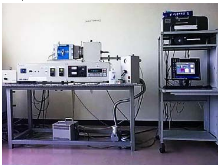
รูปที่ 3.19 เครื่องวัดสัมประสิทธิ์ซีเบ็ค ZEM-2
