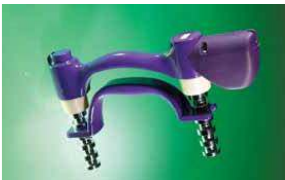
รูปที่ 2 เครื่องวัดกำลังกล้ามเนื้อมือ Grip Dynamometer (G100) Biometrics E-LINK H400S
