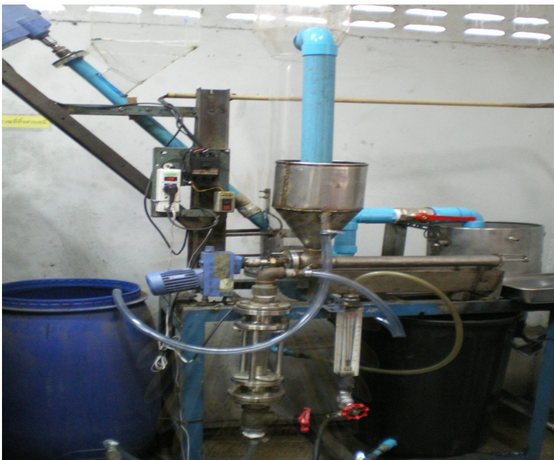
รูปที่ 3.2 เครื่องปฏิกรณ์ฟลูอิดไชน์เบดแบบสามวัฏภาคที่ใช้ในงานวิจัย
