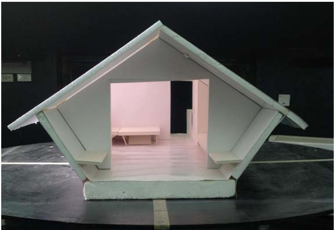
ภาพที่ 4-15 ภาพแสดงการใช้ผนังเอียง 125 องศาจากระนาบพื้น เพื่อจำลองหามุมแสงแดดในเวลาต่างกัน
