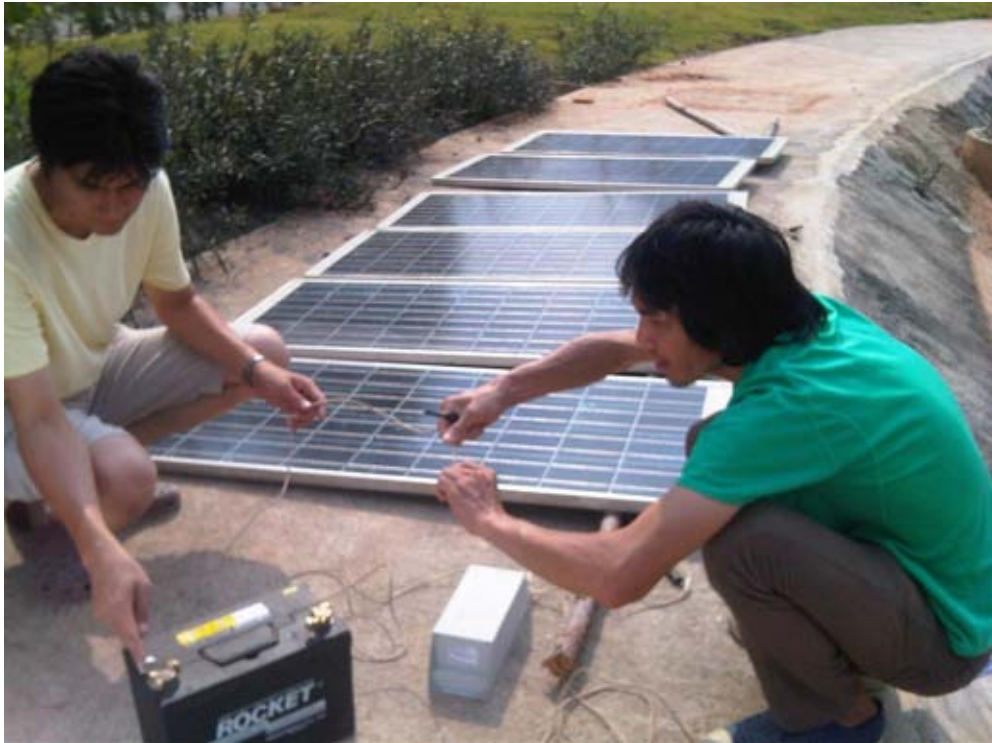
ภาพที่ 4-55 แสดงการเตรียมทดลองหาค่าพลังงานไฟฟ้าที่ได้จากแผงเซลล์แสงอาทิตย์ จำนวน 6แผง
