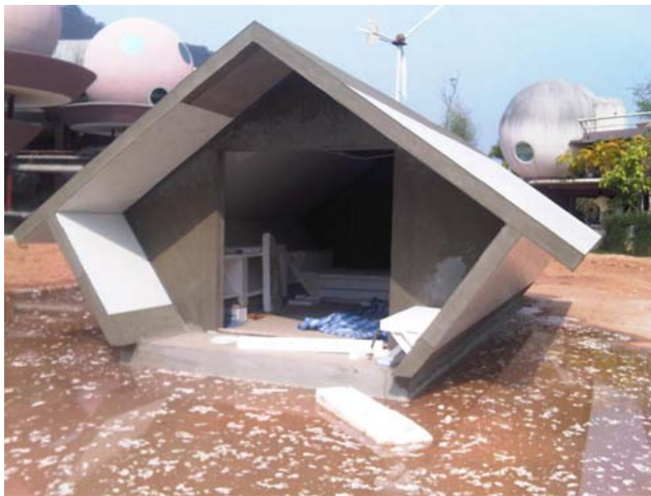
ภาพที่ 4-53 แสดงขั้นตอนการปล่อยน้ำทดสอบการลอยตัว
