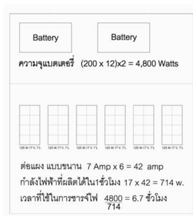
ภาพที่ 4-57 แสดงแผนผัง ระบบผลิตพลังงานสะอาดจาก ธรรมชาติที่ใช้ในบ้านลอยน้ำ
